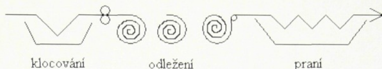
Obr. 3.9 Postup barvení Pad-Batch
