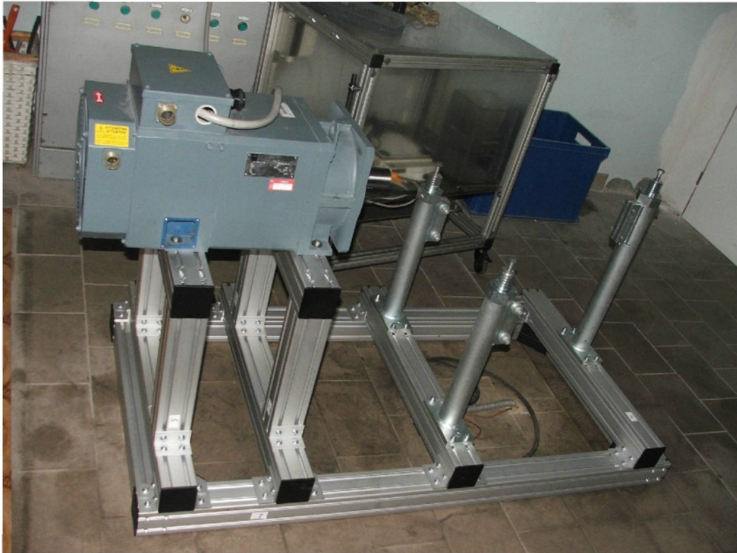
Obr. 5: Uložení spalovacího motoru
