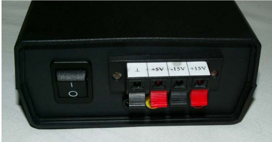
Obrázek 2-3: Čelní panel zdroje napájení se čtyřmi reprokonektory a čtyřmi banánky pro jednoduché připojení k napájenému obvodu
