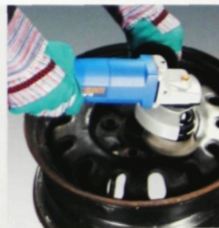
Bruska s drátěným kartáčem spolehlivě očistí i silně zrezivělý povrch nebo snadno odstraní starou barvu či nečistoty z materiálu.
