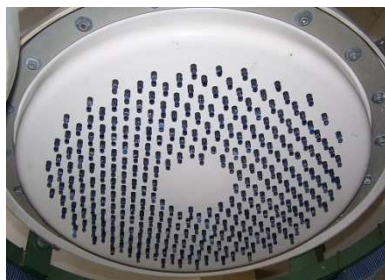
Obr. 10 Příklad přístroje Bundesmann - tvoříče kapek dle [12]
