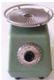
Obr. 12 Příklad přístroje Bundesmann – odstředivka dle [12]
