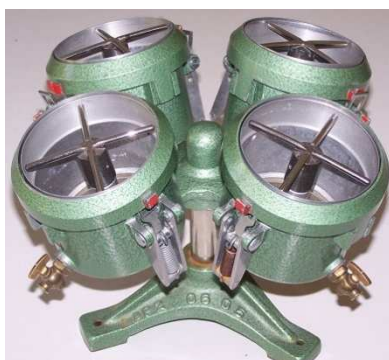
Obr. 11 Příklad přístroje Bundesmann - zařízení pro upínání zkoušených vzorků dle [12]
