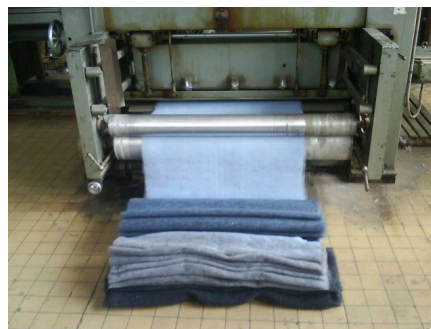
Obr. 60 Výstup z vpichovacího stroje
