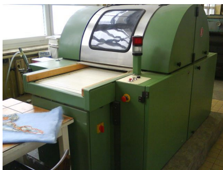
Obr. 57- 58 Mykací stroj Zdroj: vlastní fotodokumentace
