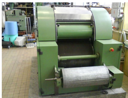
Obr. 57- 58 Mykací stroj Zdroj: vlastní fotodokumentace
