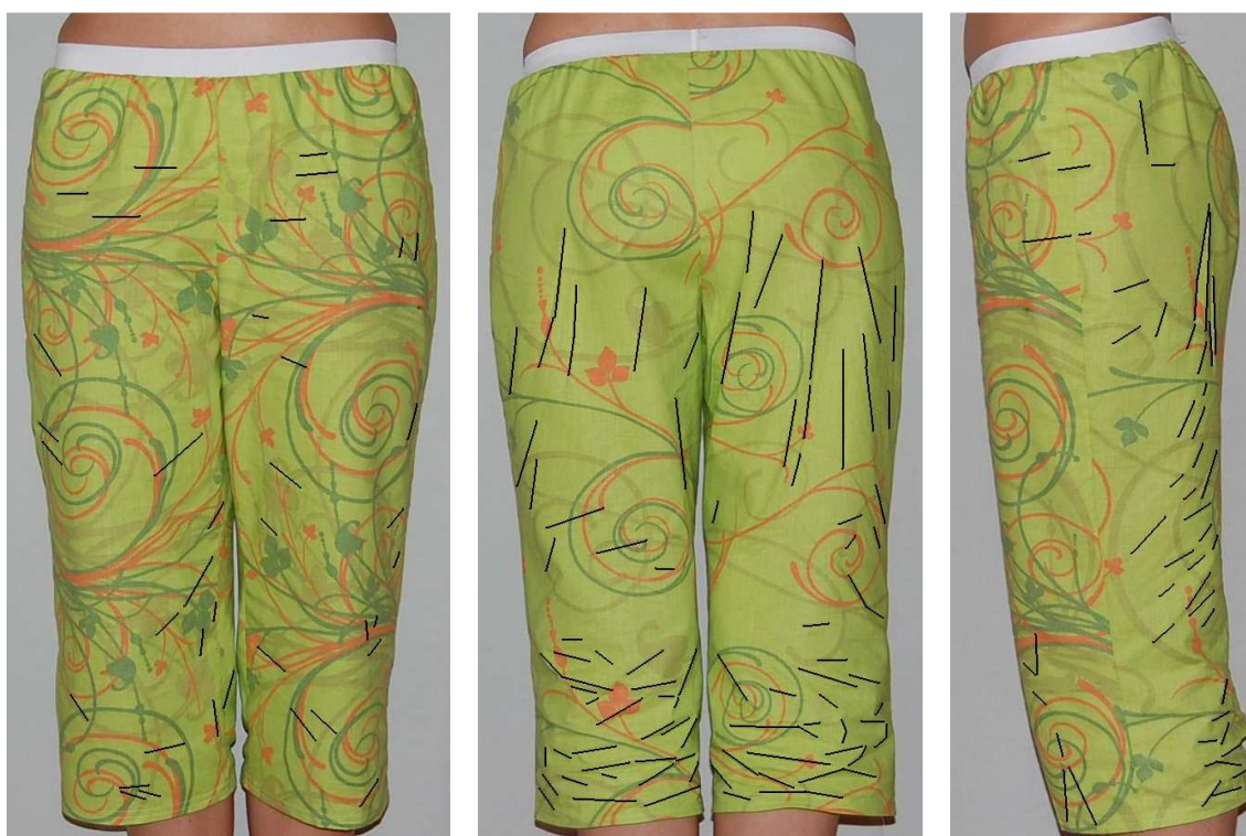
Obr. 58. Zmačkání rezné textilie U3 - po osmi hodinách nošení
