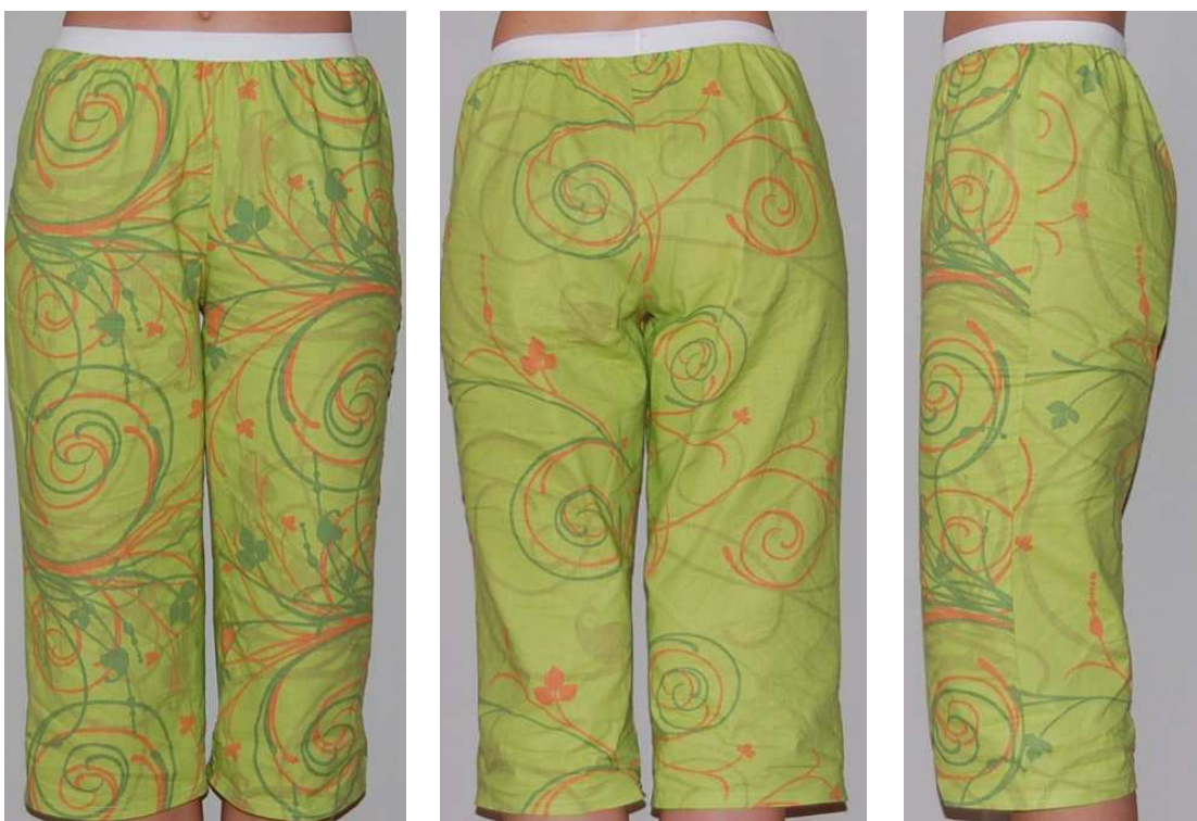
Obr. 60. Zmačkání textilie U3 po dalších 8 hodinách intenzivního zatížení během spánku
