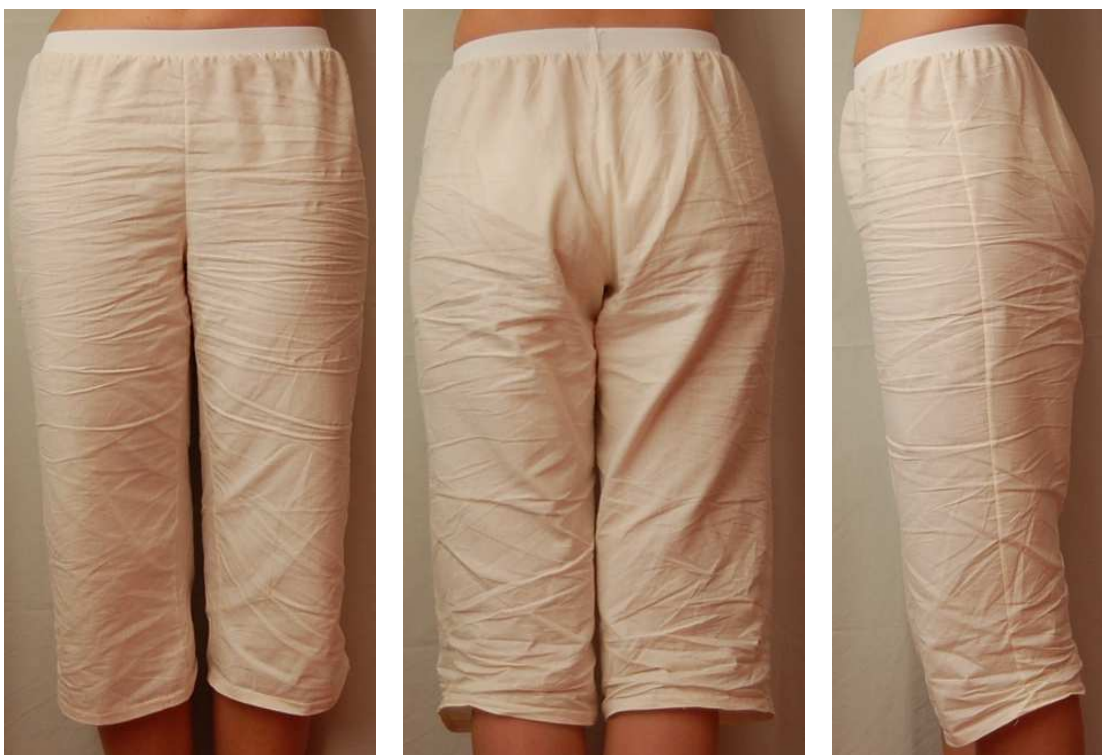
Obr. 59. Zmačkání textilie U1 po dalších 8 hodinách intenzivního zatížení během spánku
