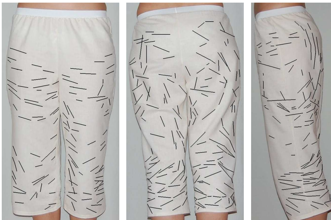
Obr. 57. Zmačkání rezné textilie U1 - po osmi hodinách nošení
