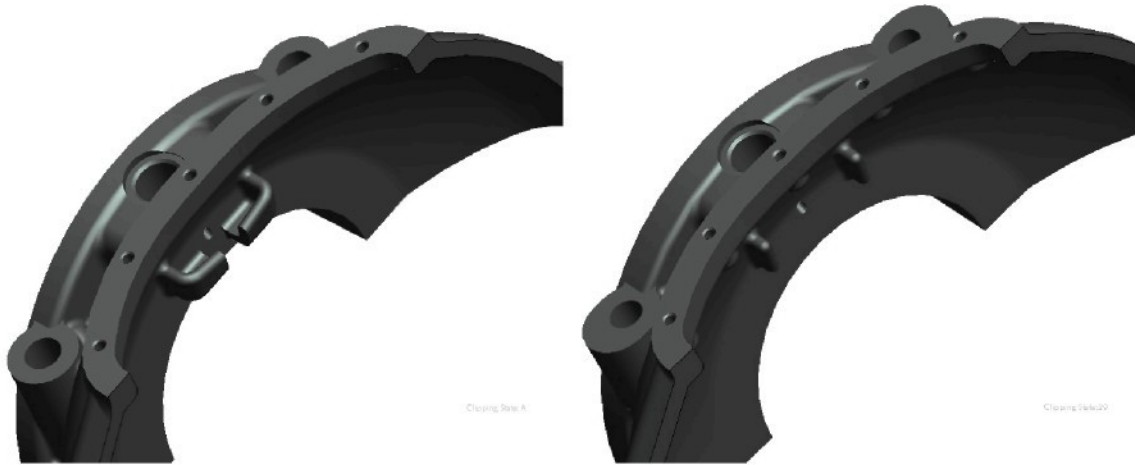
Obr. č. 29: Modifikace horního dílu převodové skříně – vnitřní nálitek.
