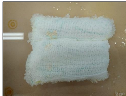
Obr. 27: Vzorek jednorázové pleny po měření nasákavosti pomocí metody 2
