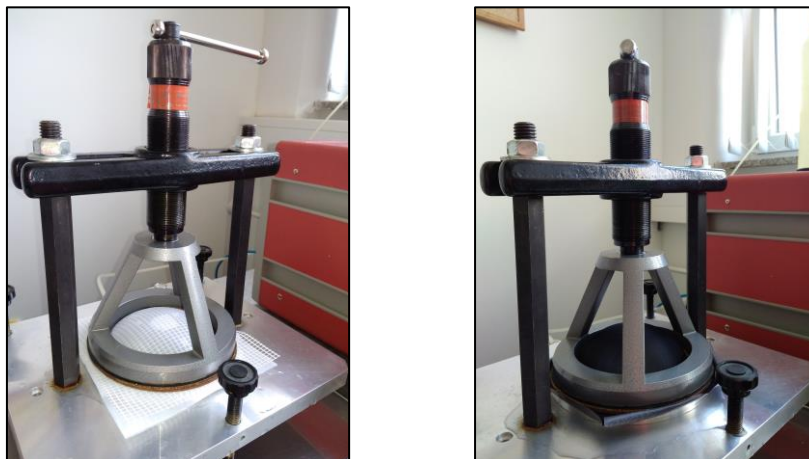
Obr. 17: Ukázka měření nepromokavosti materiálů M1 a M2 pomocí tlakové vody
