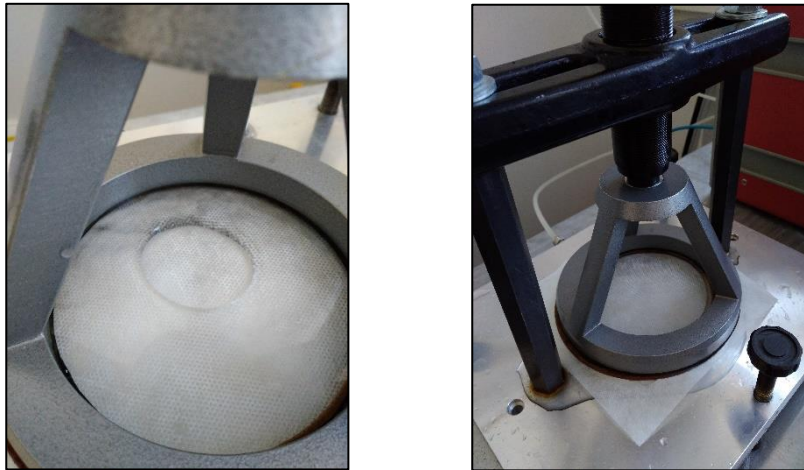
Obr. 18: Protečení zkušebního materiálu M3 při působení tlaku vody
