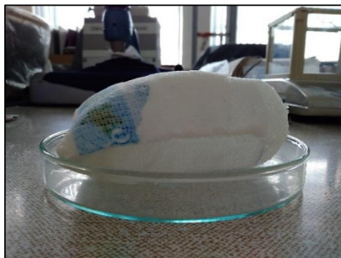
Obr. 24: Vzorek jednorázové pleny po měření nasákavosti
