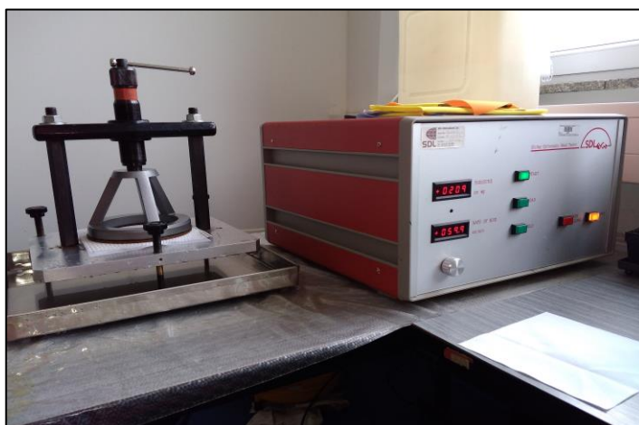
Obr. 16: Přístroj SDL M018 pro měření odolnosti proti pronikání vody
