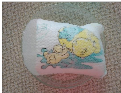
Obr. 24: Vzorek jednorázové pleny po měření nasákavosti
