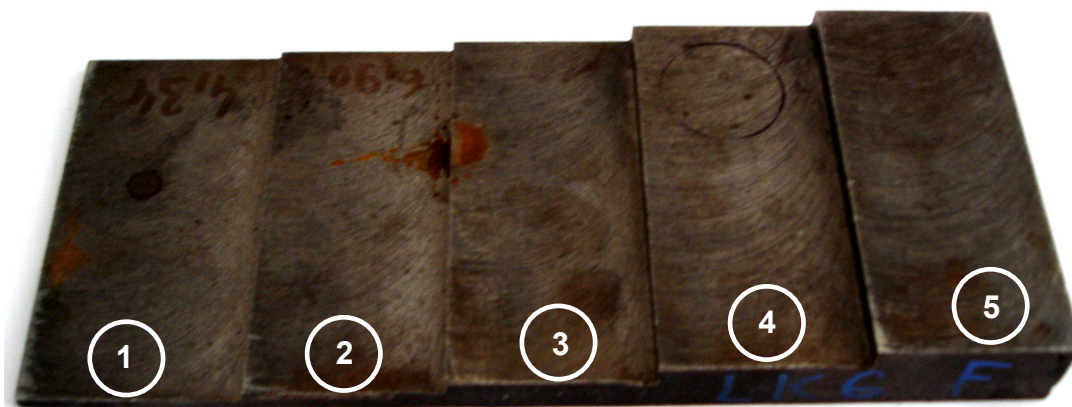
Obr. 4.1. Zkušební těleso - Stupňovitá měřka
