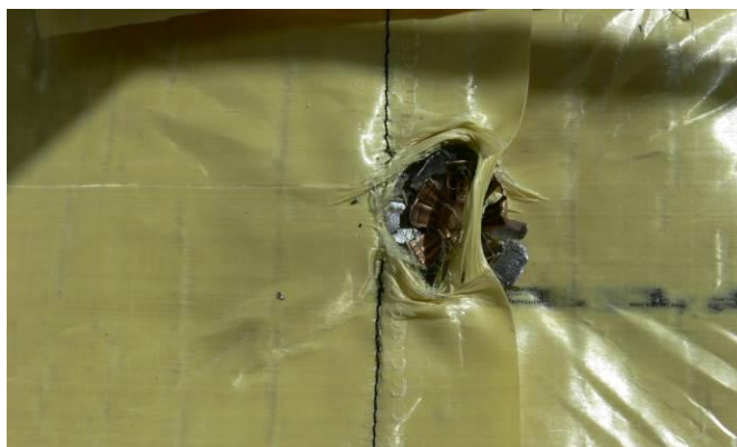
Obr. 55: Deformace střely a materiálu v místě dopadu střely
