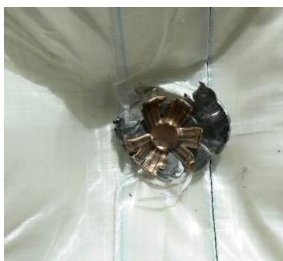
Obr. 57: Deformace střely, mechanické rozrušení materiálu v místě dopadu střely
