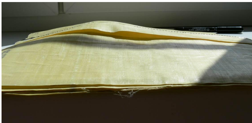
Obr. 54: Traumatická deformace – vzorek 3
