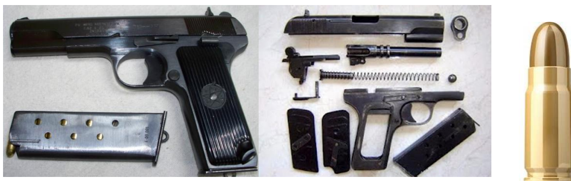
Obr. 22: České testované náboje z Vlašimi Sellier a Bellot, náboj 7.62x25 mm probije IIA i IIIA stupeň NIJ normy odolnosti, zbraň ruský Tokarev TT33 [28]
