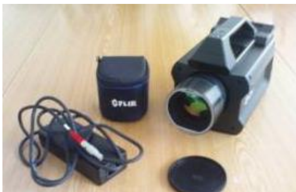
chlazený termografický systém FLIR SC6540, ukázka analyzování teplotních polí
