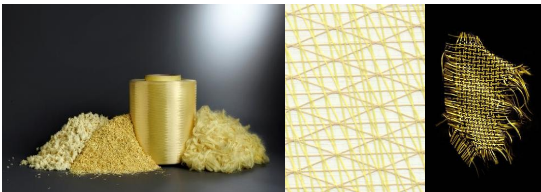
Obr. 12: Kevlar příze, stříž, drť, vrstvení pro výtuhu v lodích. Vpravo hybridní tkanina s uhlíkovými vlákny [31]
