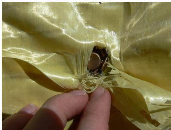
Obr. 59: Střela zavrtnaná v prvních vrstvách vzorku
