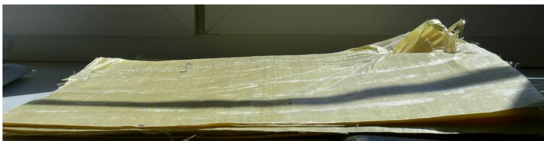
Obr. 58: Traumatická deformace – vzorek 5
