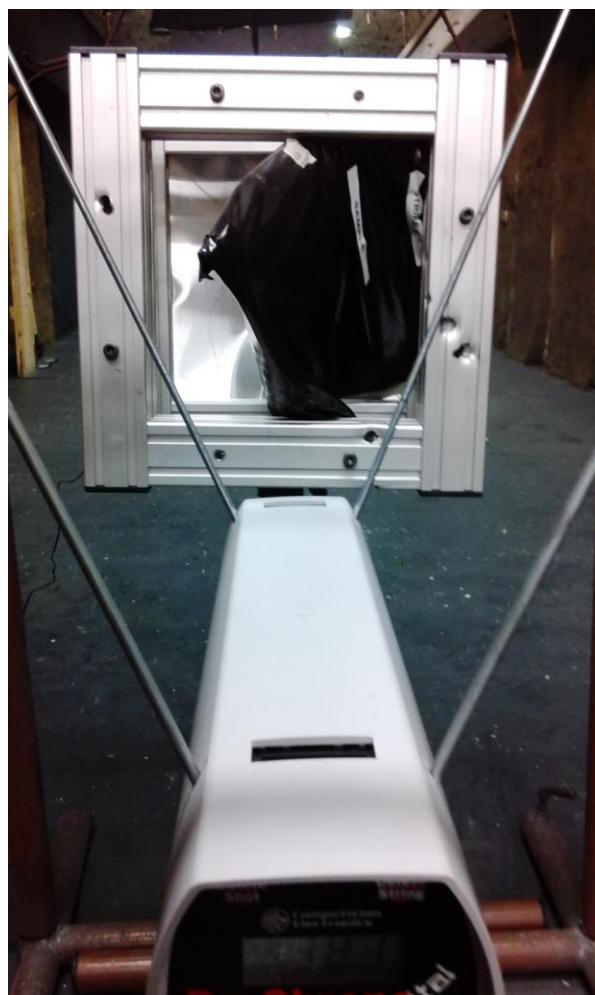
Střelna Army Arms, testovací zařízení (hradla Competition Electronics Pro Chrono Digital měřidla rychlosti střely) a rám se vzorkem.
