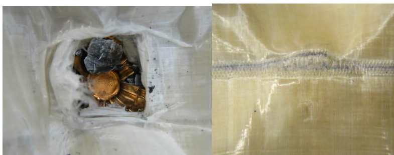
Obr. 53: Dopad střely, deformace ultrazvukového spoje
