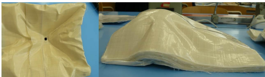
Obr. 50: Traumatická deformace – vzorek 1
