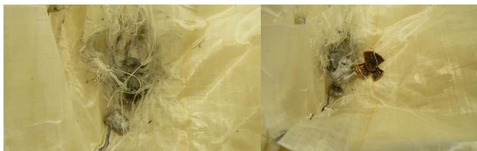
Obr. 51: detail vstřelu v místě švu
