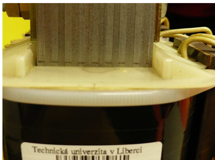
Obrázek 27: Fotografie měřeného transformátoru, s detailem vzduchové mezery
