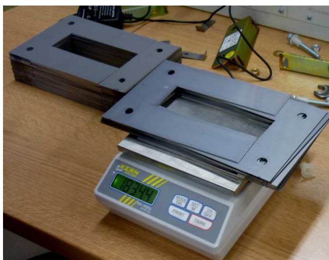
Obrázek 28: Fotografie použité digitální váhy při měření hmotnosti jádra
