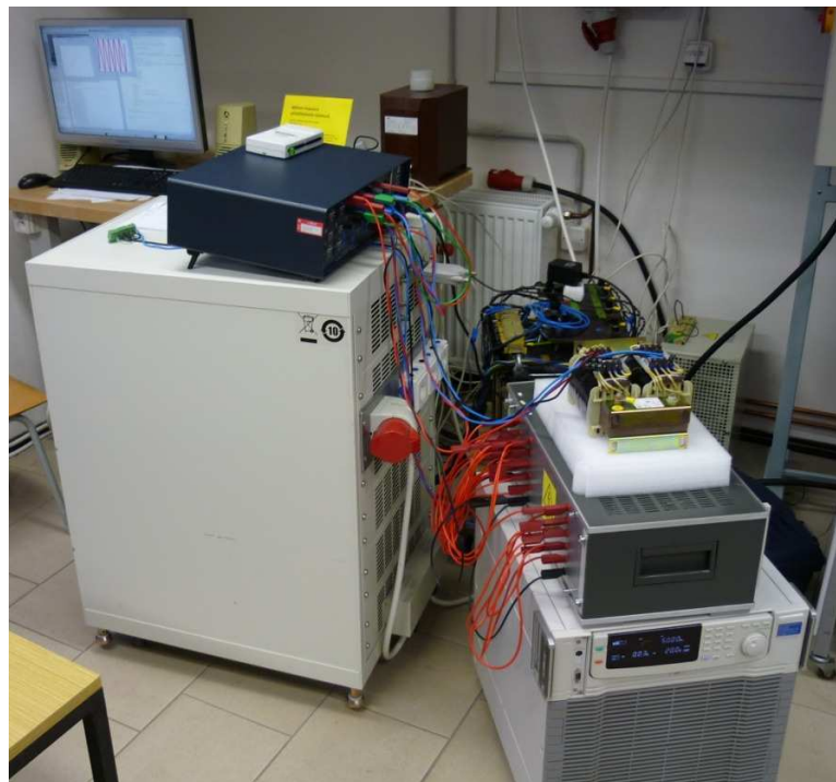
Obrázek 19: Fotografie měřicí aparatury ztrát naprázdno
