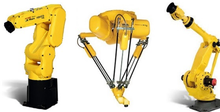
Obrázek 3.2: Vlevo příklad sériové kinematiky, uprostřed paralelní a poslední smíšené, upraveno z [1]
