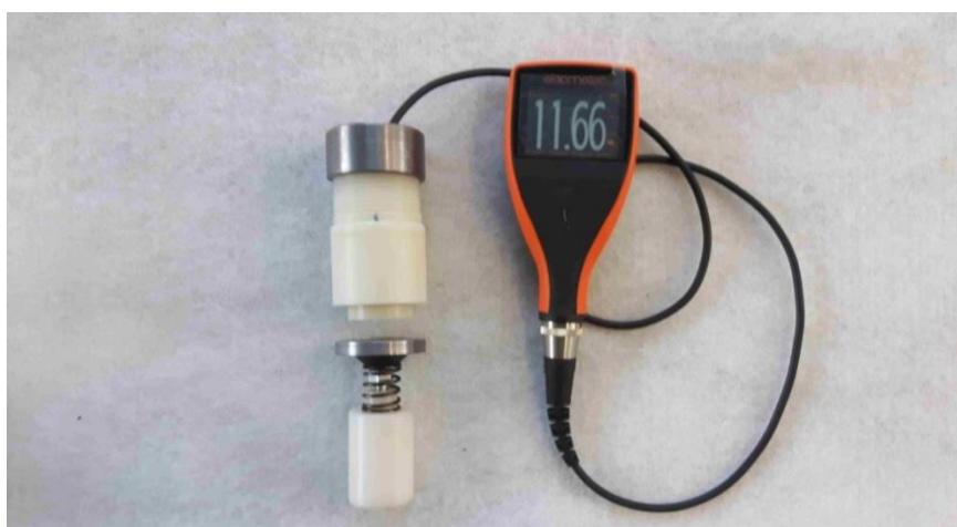
Obrázek 35: Elcometer 456 s upravenou měřicí sondou a odraznou plochou
