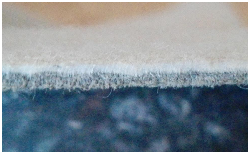
Obrázek 17: Výsledná vlákenná vrstva s viditelně čistým řezem
