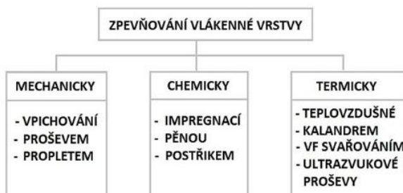
Obrázek 2: Zpevňování vlákné vrstvy [2]
