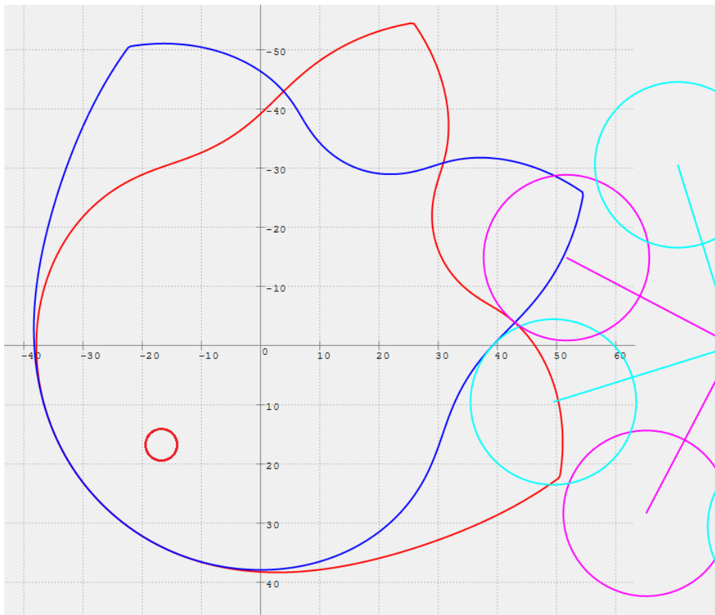
Obr. 4.7 Složená radiální symetrická dvojvačka
