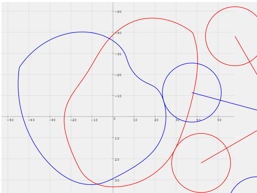
Obr. 4.8 Složená radiální nesymetrické dvojvačka
