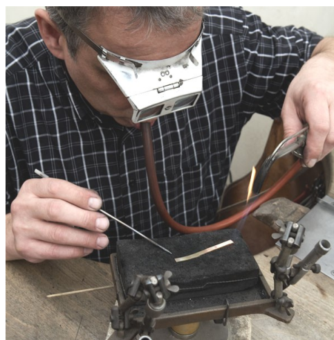
Obrázek 8 - zlatník při pájení (žihání)
