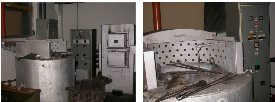
Obr.2.1.2.1: Zařízení pro izotermické kalení v soli – TEDOM, a.s.
