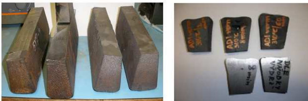
Obr.2.1.3.3: Zkušební Y bloky, vzorky z Y bloků.
